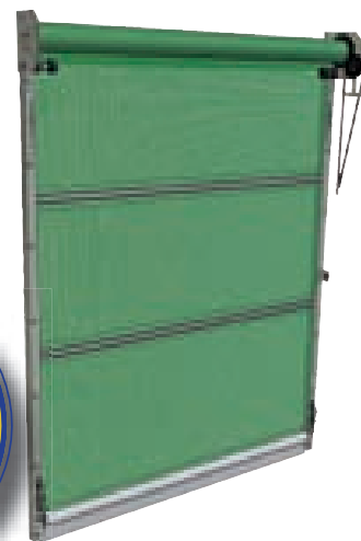
Das Agrartor ist seitlich geschlossen. Die horizontalen Rohre bieten eine Stabilisierung und Verstärkung des Netzes. Das Tor ist über einen Kettenantrieb oder gegen Aufpreis mit Motorantrieb und Fernbedienung einfach und schnell zu bedienen.
